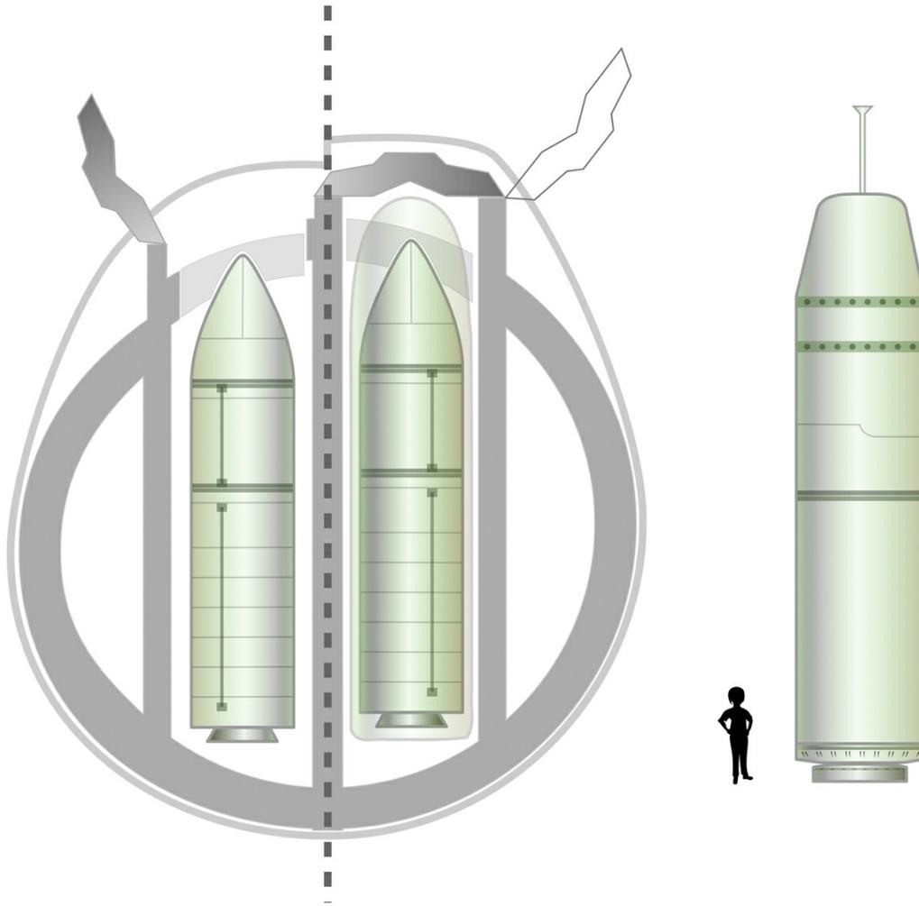
**Abbildung 3: M45 und M51 Interkontinentalraketen in den Hüllen der französischen Atom-U-Boote SNLE (Typ Redoutable = schrecklich, fürchterlich, links) und SNLE-NG (Typ Triomphant, rechts), Grafik 2005-10-02 Vector version by Dake. Based on a drawing by Rama. (Quelle: Wikimedia (CC BY-SA 3.0))**
