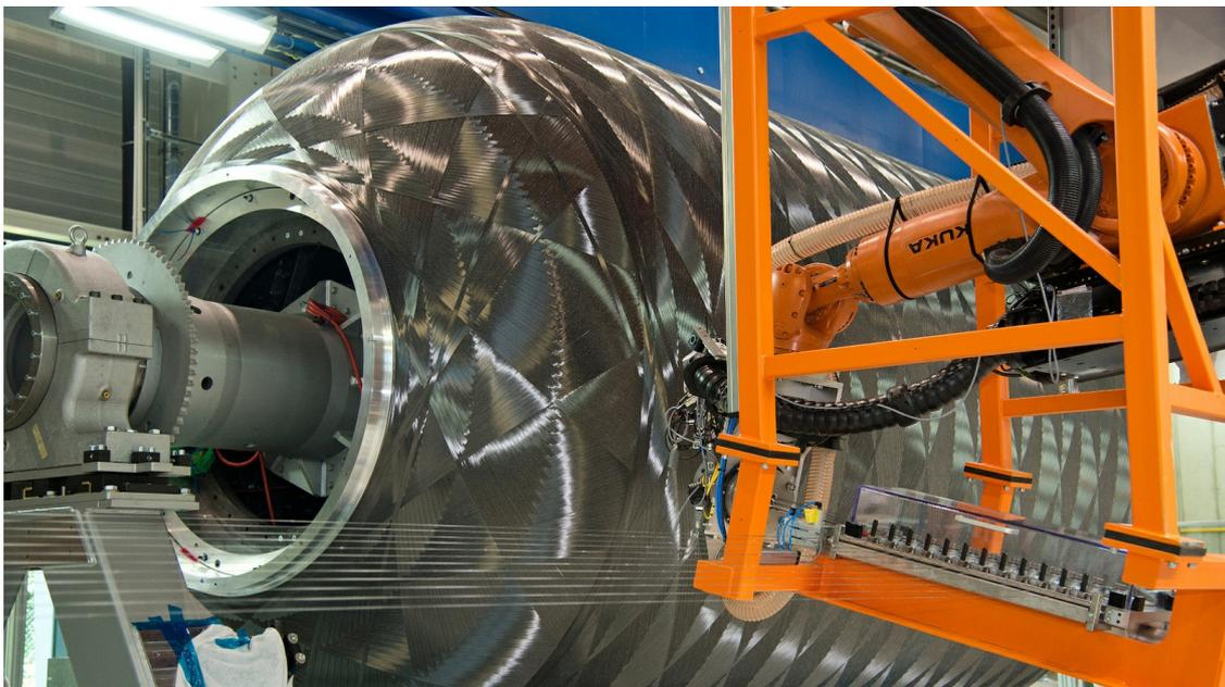
**Abbildung 1: Das Boostergehäuse aus Carbonfasern für die Ariane 6 wurde beim DLR Stuttgart und Augsburg in Kooperation mit MT Aerospace entwickelt und gefertigt. Foto: 2015-07-01 (Quelle: DLR (CC-BY 3.0))**
