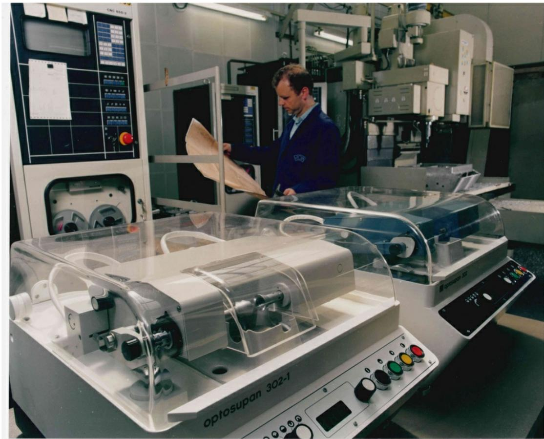
**Bild 4: Neue Brillenglas-Randschleifmaschinen im ROW-Fräszentrum 1992. Foto: Mikroskop-Technik Rathenow GmbH**
